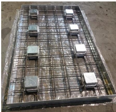
Llosa amb els molls (sense formigonar, al taller)
