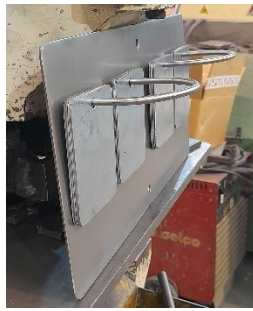
Fabricació per a petita ferramenta com a marcador / puntuació, en acer inox
