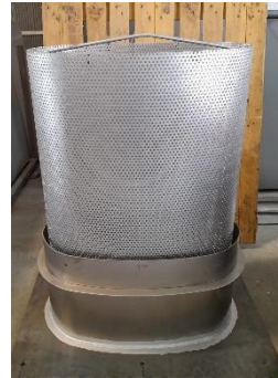
Filtre interior doble xapa perforada (galva)
