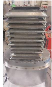
Filtre interior perfils en Z (en negre)
