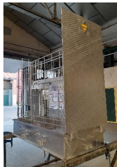
Trapa hidráulica acabado superior con chapa estriada
