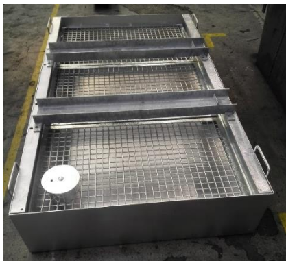
Depósito con raíles paralelos al lado corto (en taller)
