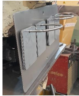
Fabricación para pequeño herraje como marcador / puntuación, en acero inox
