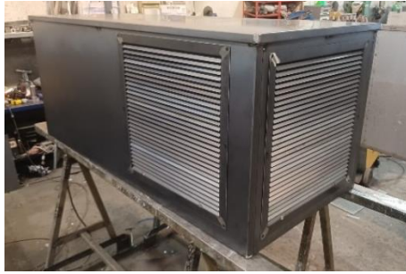
Boîte de ventilation en acier Corten (La finition à l'aspect corten est obtenue avec le vieillissement du matériau déjà traité)
