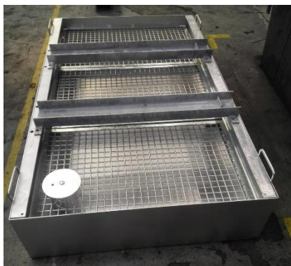
Réservoir avec rails parallèles au côté court (en atelier)
