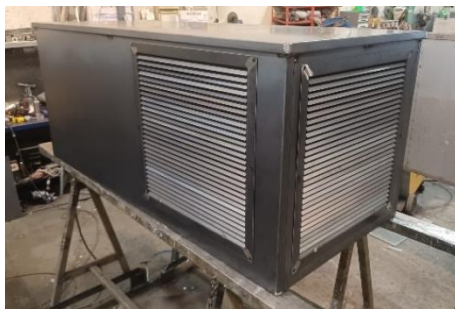
Scatola di ventilazione in acciaio corten (la finitura effetto corten si ottiene con l'invecchiamento del materiale già trattato)
