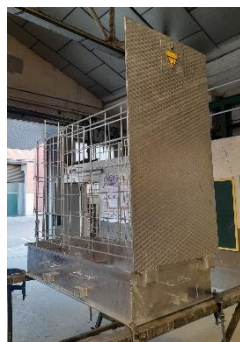
Sifone idraulico di finitura superiore con piastra scanalata
