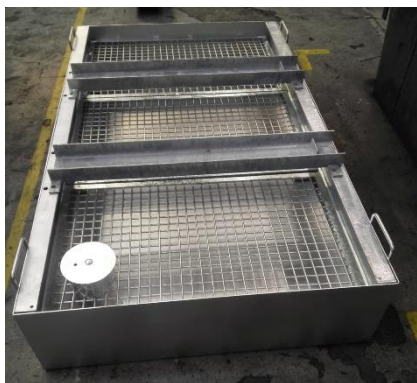
Tanque com trilhos paralelos ao lado curto (em workshop)
