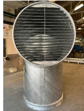
Fabricação de ventilação de grandes dimensões, tipo barco.
