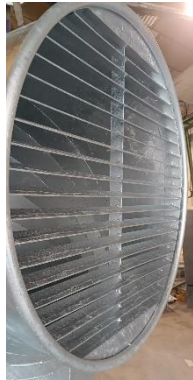
Fabricação de ventilação de grandes dimensões, tipo barco.
